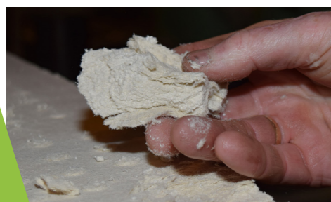
Ferdig tremasse med 12 % vann.
